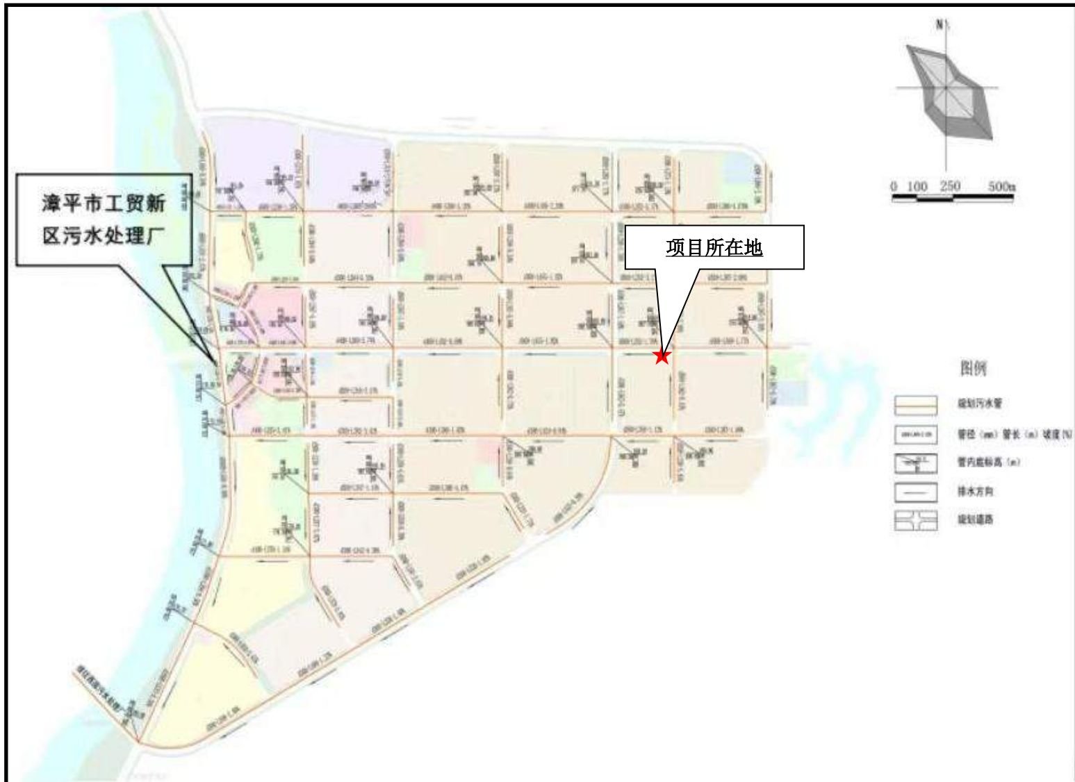
附图 7 登榜工业园区污水管网图
