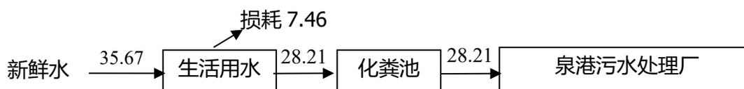
图 2-1 项目水平衡图 (t/d)
