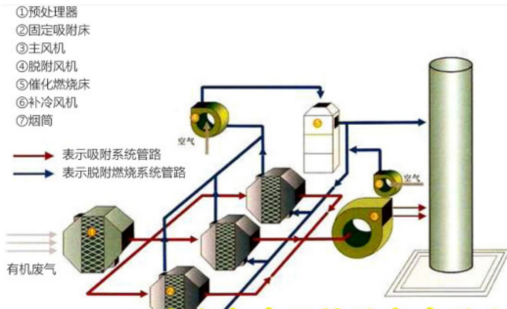
图 4-2 RCO 废气处理设备图
