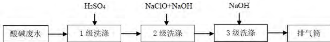
图 3.1-32 酸碱废气洗涤塔处理工艺流程图
