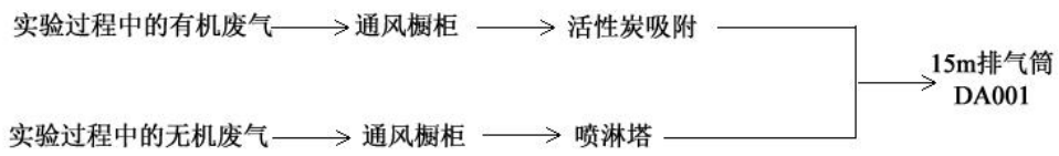
图 4-3 项目废气收集、处理、排放流程示意图
