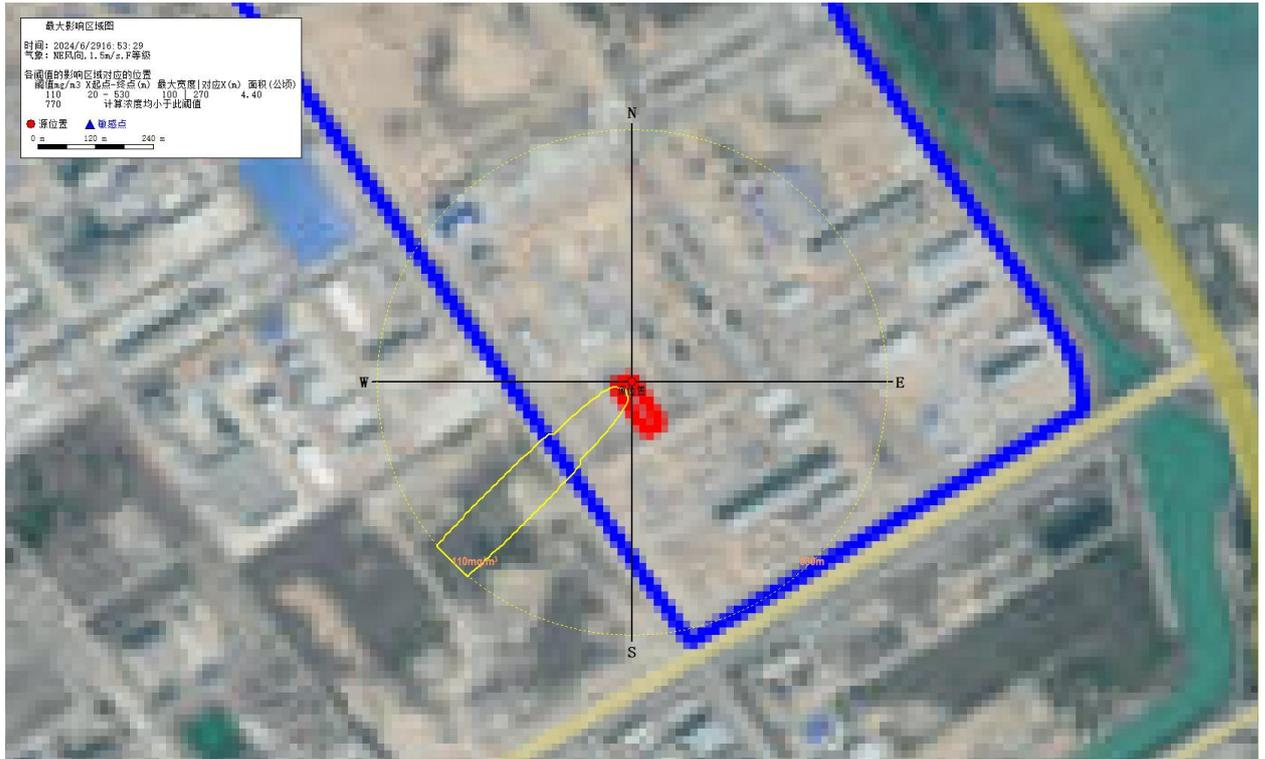
图 7.8-3 最不利气象条件下氨缓冲罐泄漏氨气影响范围
