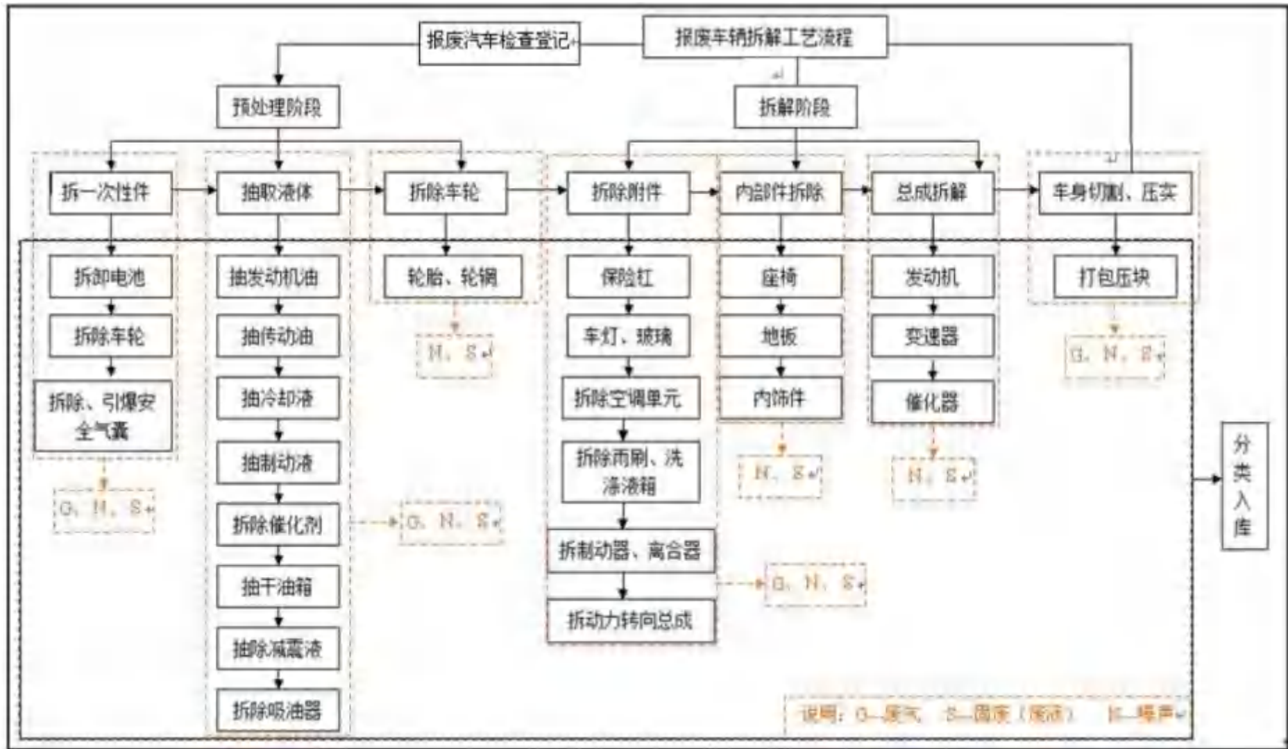
图 2.3-1 汽车拆解工艺流程及产污环节图
