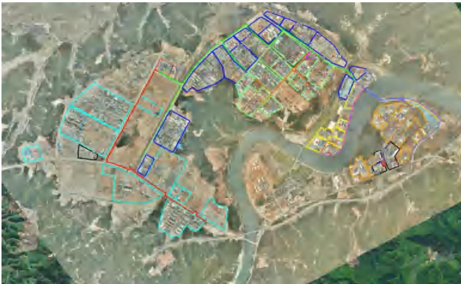
注：实现部分为已建成供热管网，虚线部分为拟建或正在建设部分供热管网。
