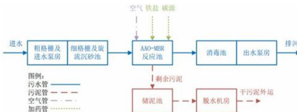
图 4.2.2-2 南溪湾污水处理厂处理工艺流程图
