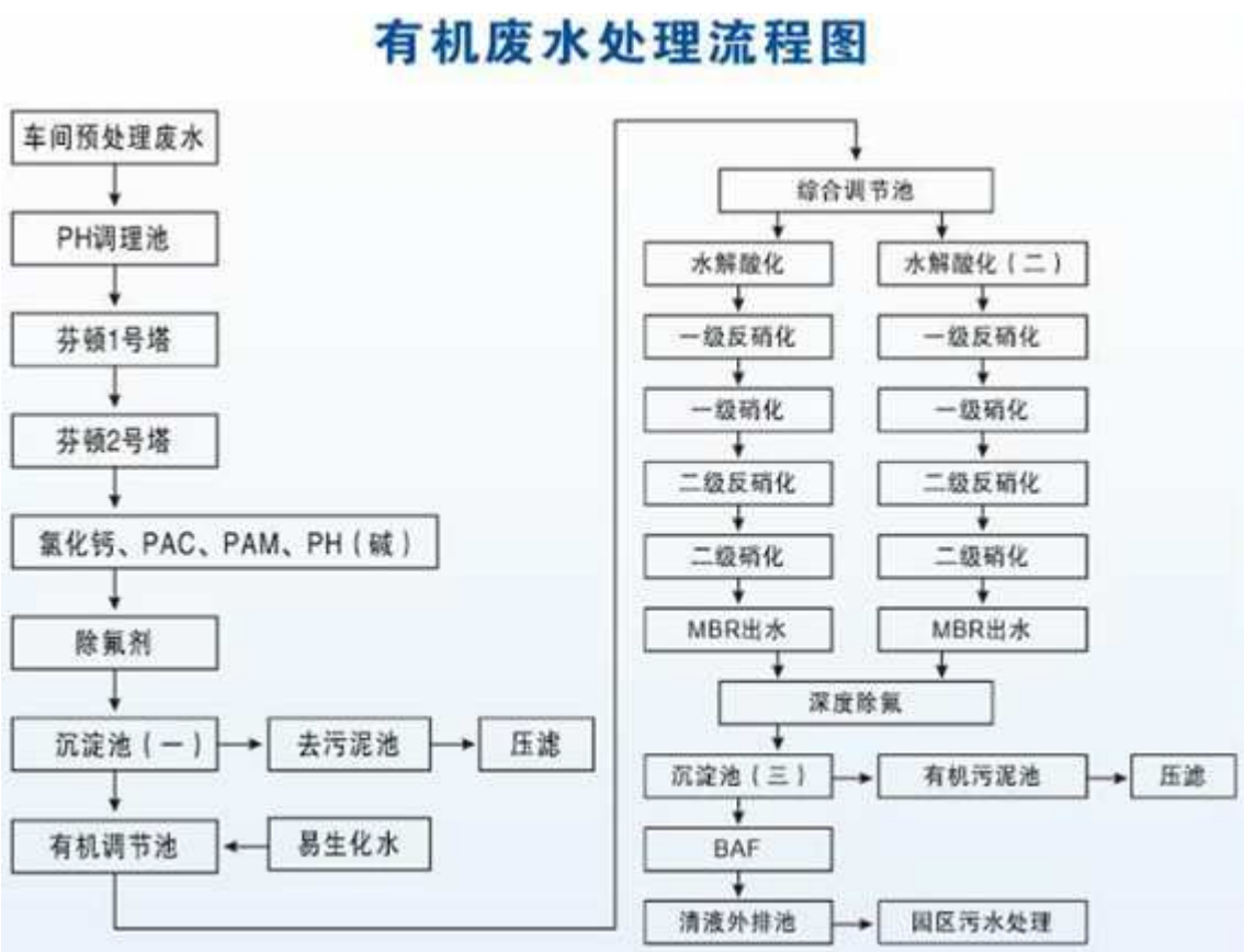
图 2.4-4 企业现有有机废水处理站处理工艺流程图
