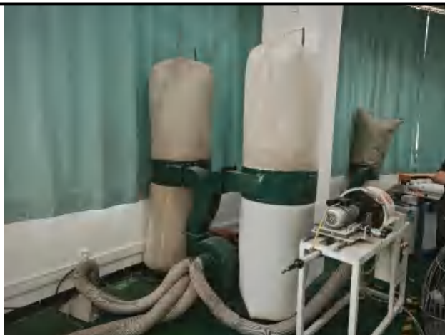
分切工序配套双桶布袋除尘器
