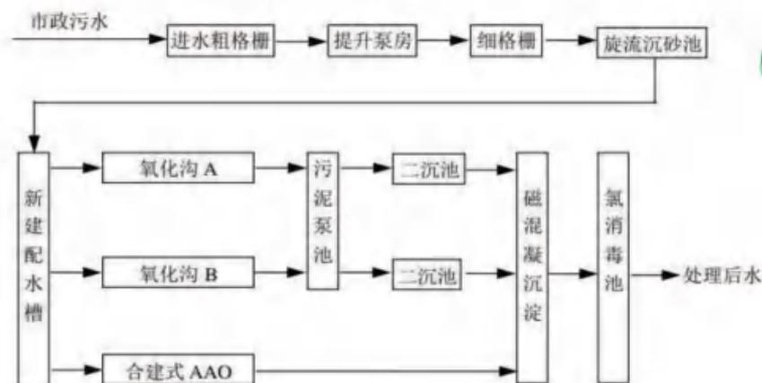
图 4-5 漳浦县城区污水处理厂提标改造后污水处理工艺流程图
