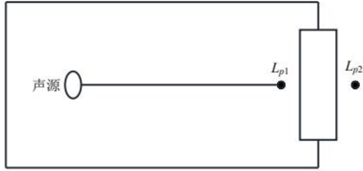
图 4-3 室内声源等效为室外声源图例
