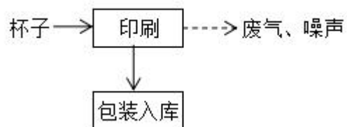
图 2-3 杯子生产工艺及产污环节流程
