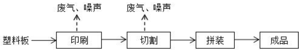
图 2-2 塑料板生产工艺及产污环节流程
