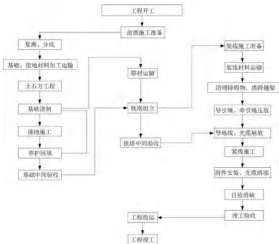
图 2.7-3 架空线路施工工艺
