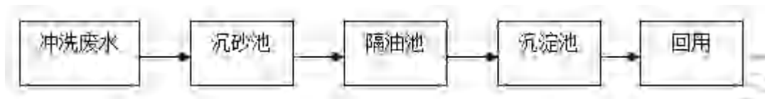
图 6.1-1 生产废水处理措施工艺图
