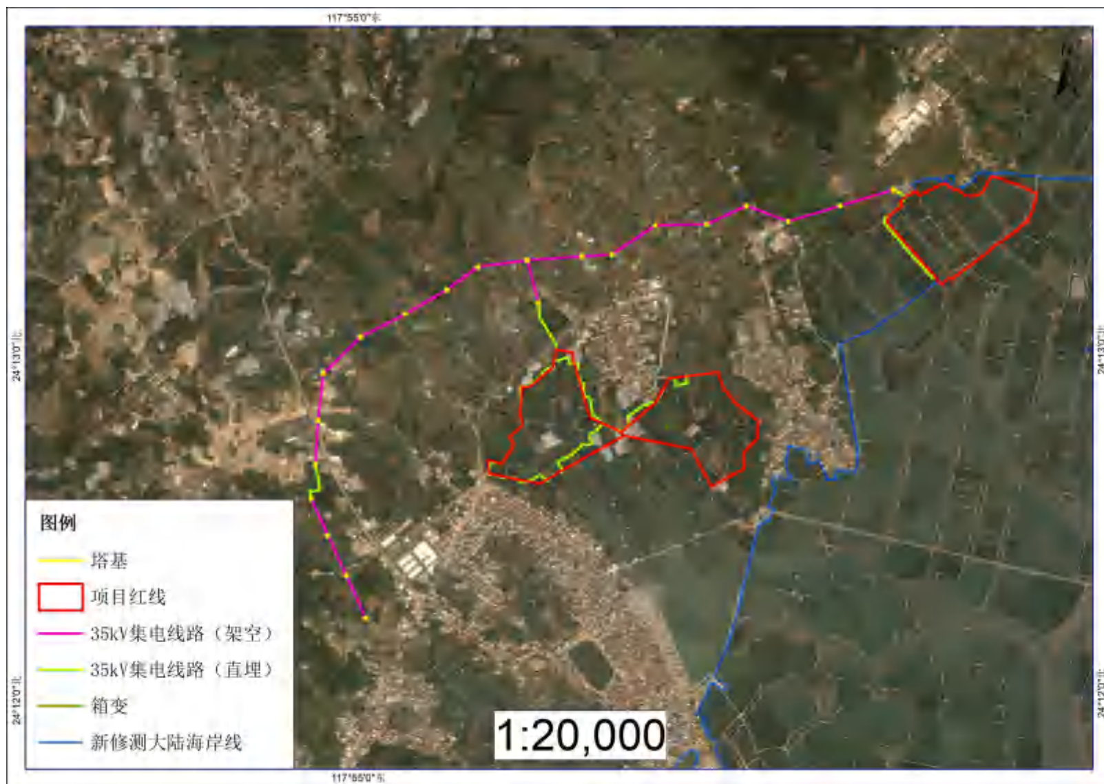
图 2.5-10b 电缆布设示意图（光伏区 A、B、C）
