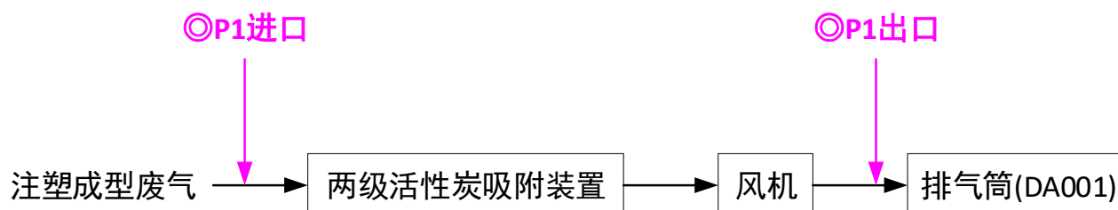
图 3-2 项目废气处理设施及监测点位
