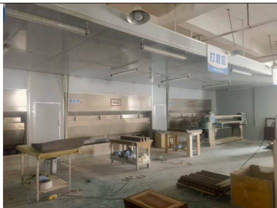
打磨工序——水帘除尘
