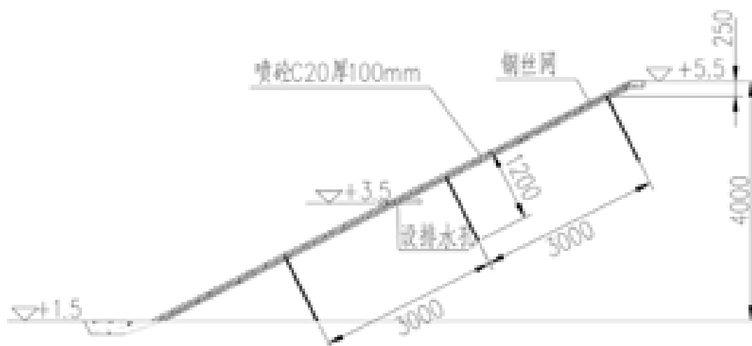
图 2.1-8 喷射砼护面详图
