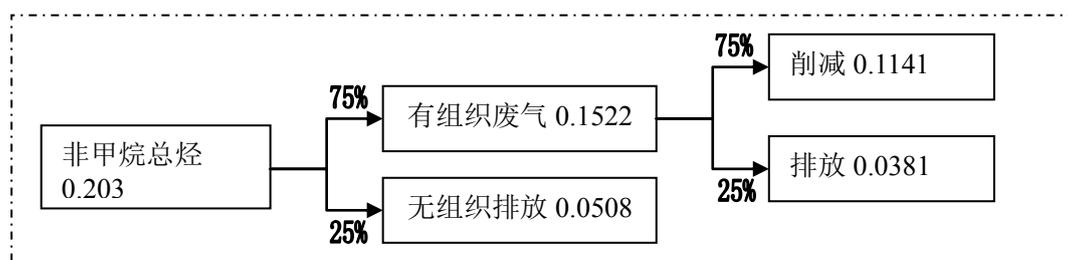
集气效率参考《主要污染物总量减排核算技术指南（2022 年修订）》中“表 2-3 VOCs 废气收集率和治理设施去除率通用系数”，生产过程车间关闭门窗，烘箱全密闭，仅留生产线出入口采用包围型集气罩收集，集气效率按 75% 计，有机废气通过两级活性炭吸附处理，净化效率按 75% 计算，本项目拟提升风量为 15000 m<sup>3</sup>/h，年工作时间 2400h，废气产生及排放情况见下表。
