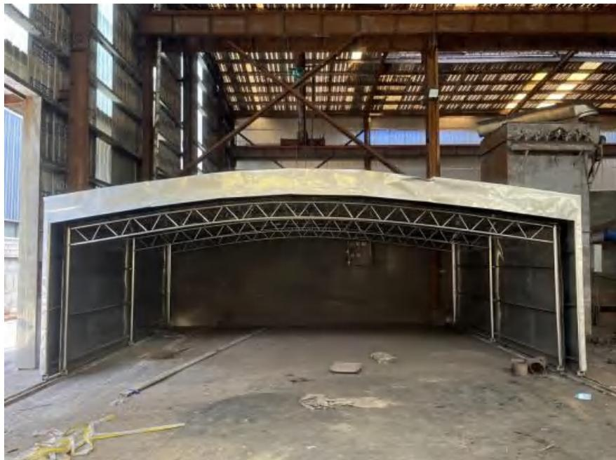
图 3.1-1 包围型移动集气罩示例
