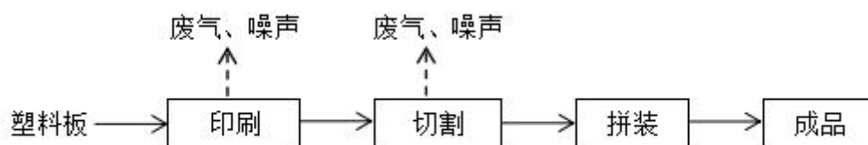
图 2-2 塑料板生产工艺及产污环节流程
