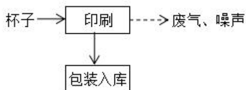
图 2-3 杯子生产工艺及产污环节流程
