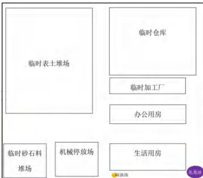
图 2.7-2 本项目依托工程（升压站施工营地）总平面布置图
