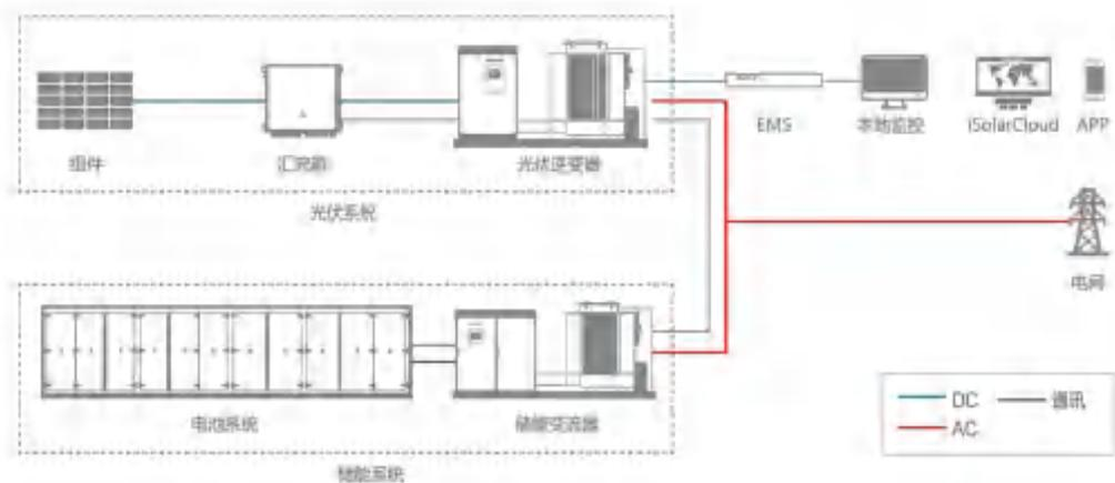
图 2.5-16 储能系统结构图
