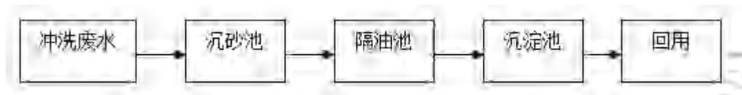
图 6.1-1 生产废水处理措施工艺图
