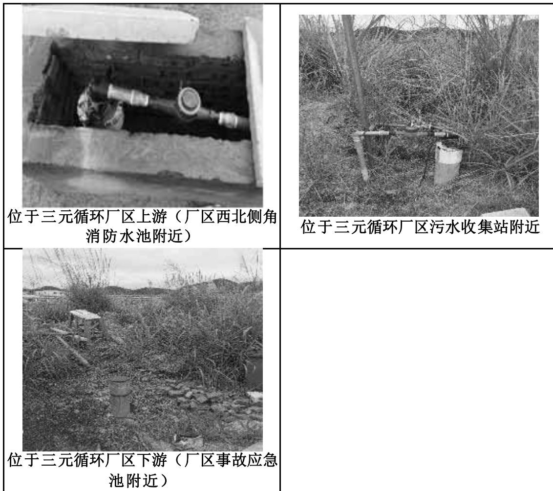
图 4.2-5 厂区地下水监控井设置现场情况图
