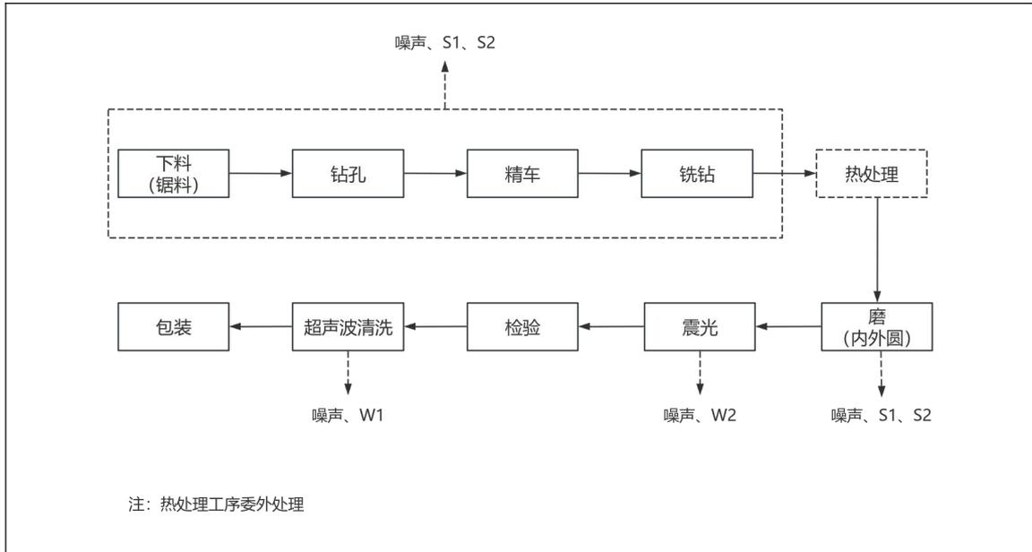
图 2.8-1 锂电工具配件生产工艺流程图
