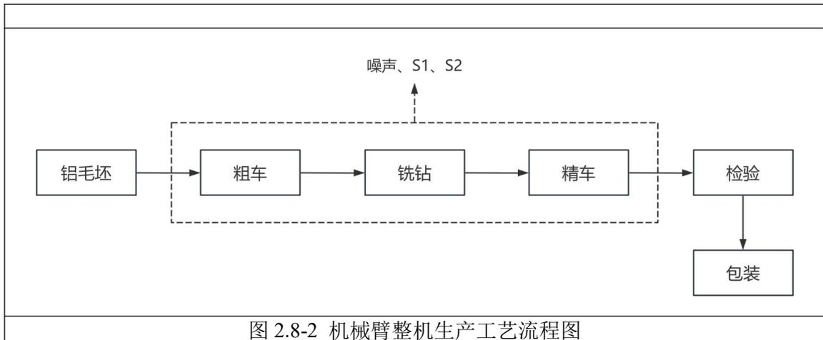
图 2.8-2 机械臂整机生产工艺流程图
