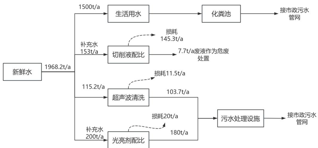
图 2.6-1 本项目水平衡图（单位：t/a）
