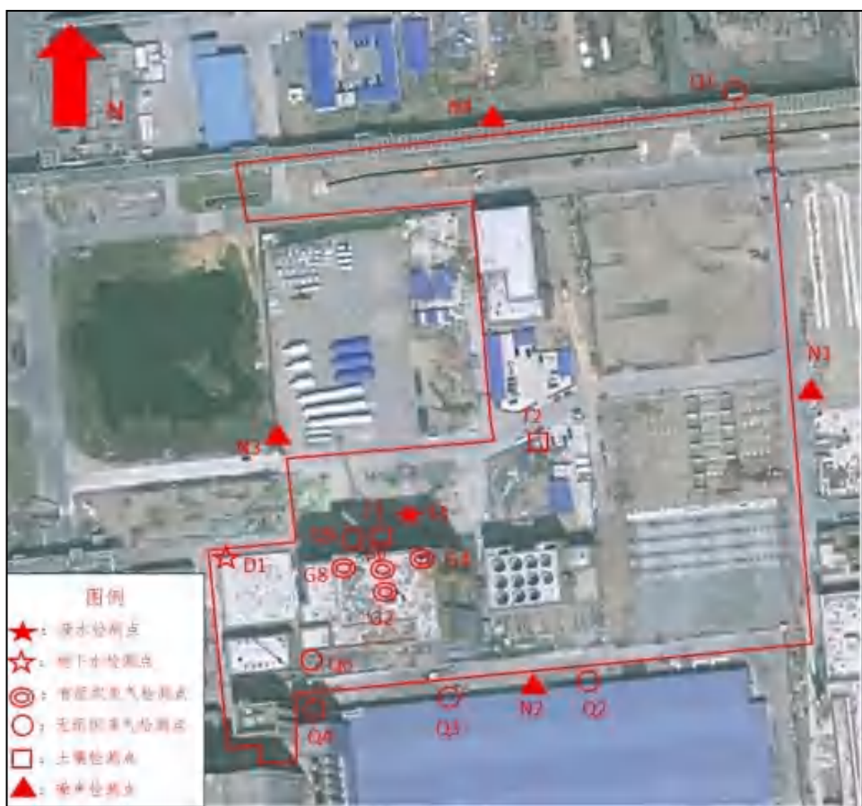
图 7.2-2 土壤、地下水、废水、废气、噪声采样点位示意图
