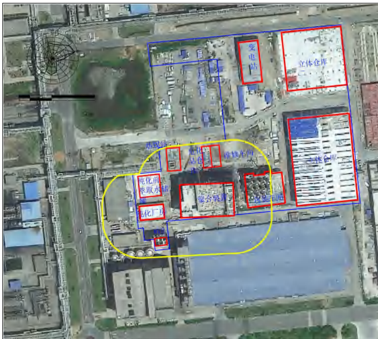
图 3.1-5 全厂环境保护距离图包络图
