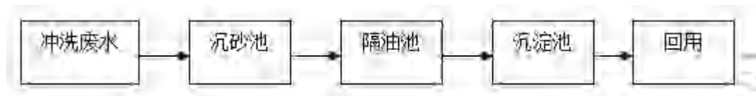
图 6.1-1 生产废水处理措施工艺图
