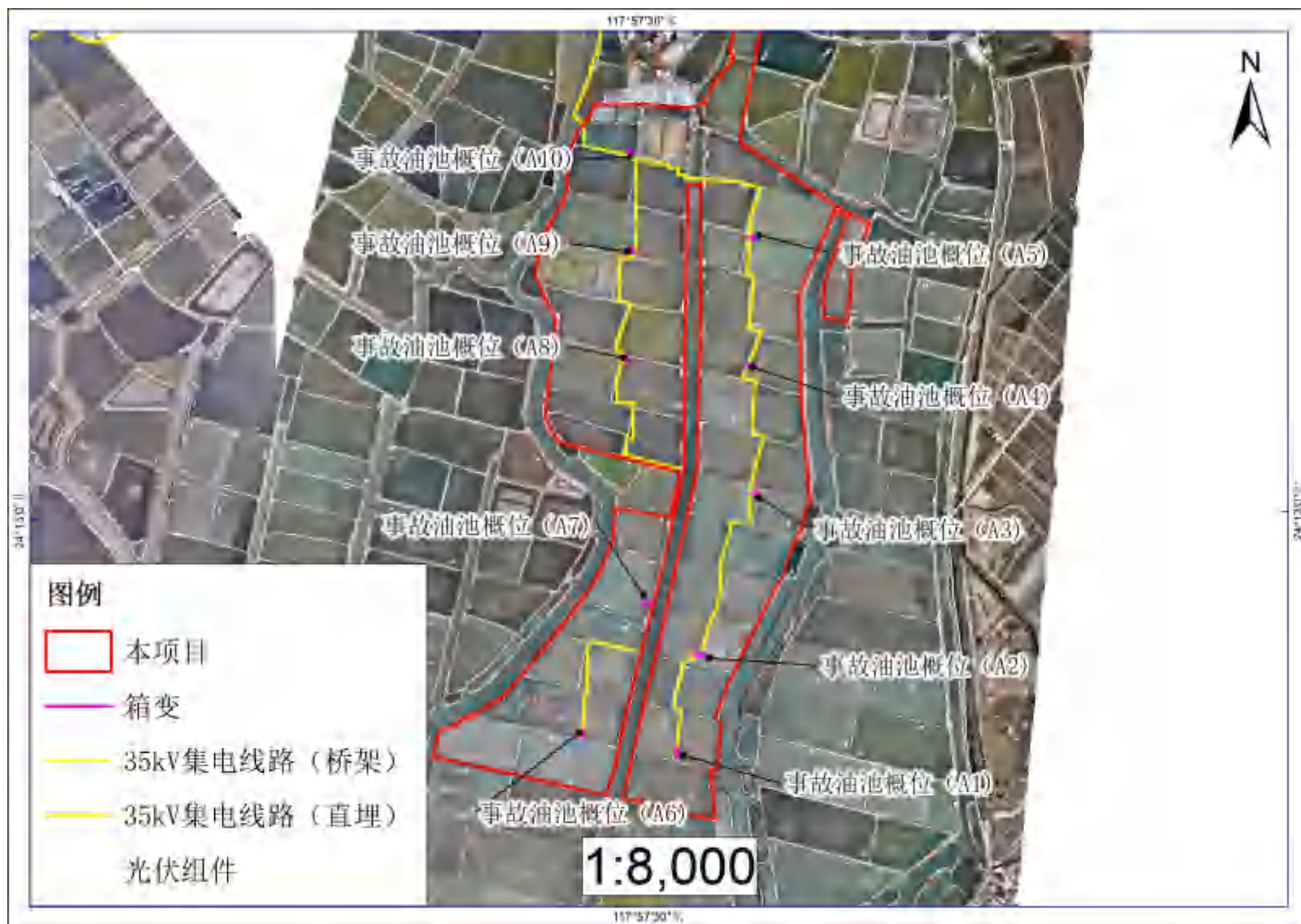
图 2.5-16 光伏区事故油池概位
