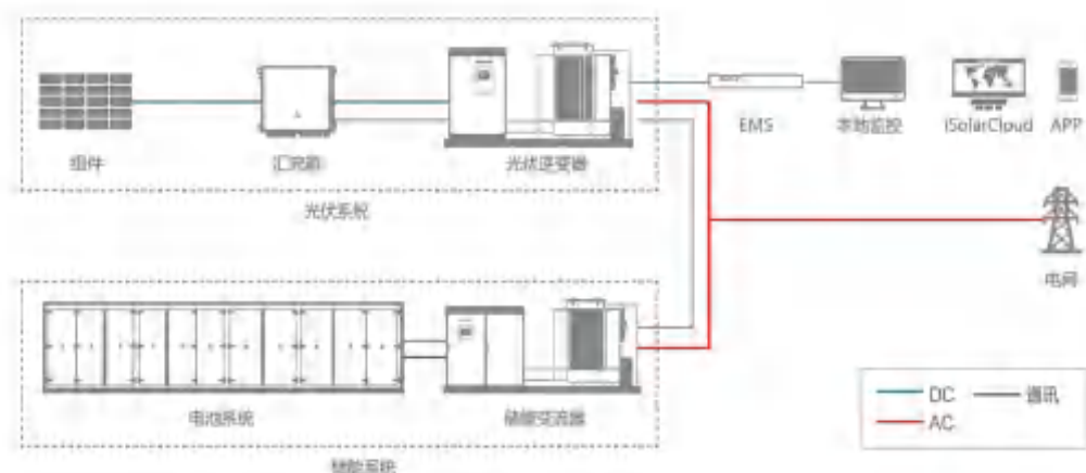
图 2.5-16 储能系统结构图
