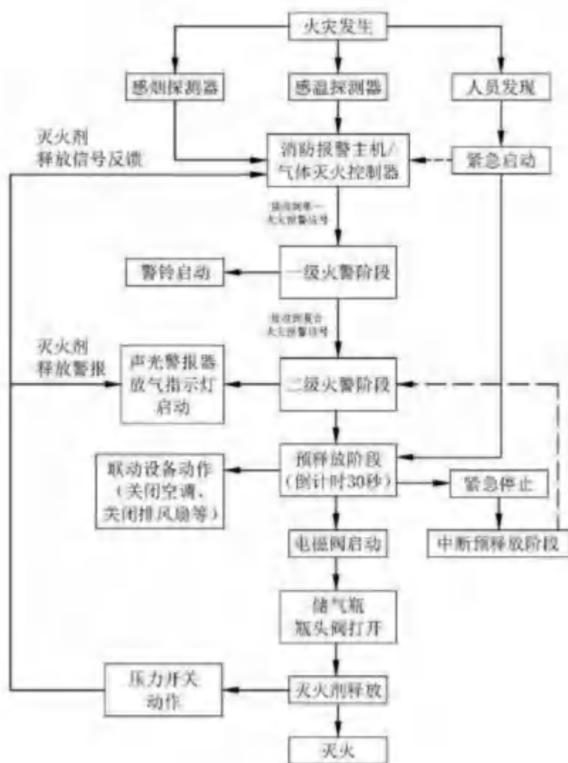
图 5.5-1 灭火流程图
