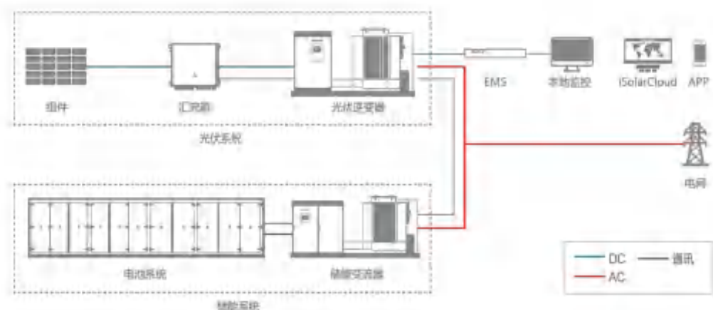
图 2.5-16 储能系统结构图
