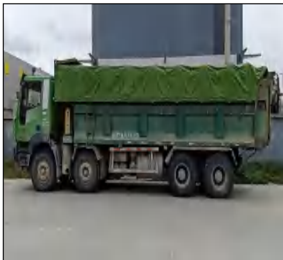
图 4-1-15 运输车加高车斗，并用帆布遮盖
