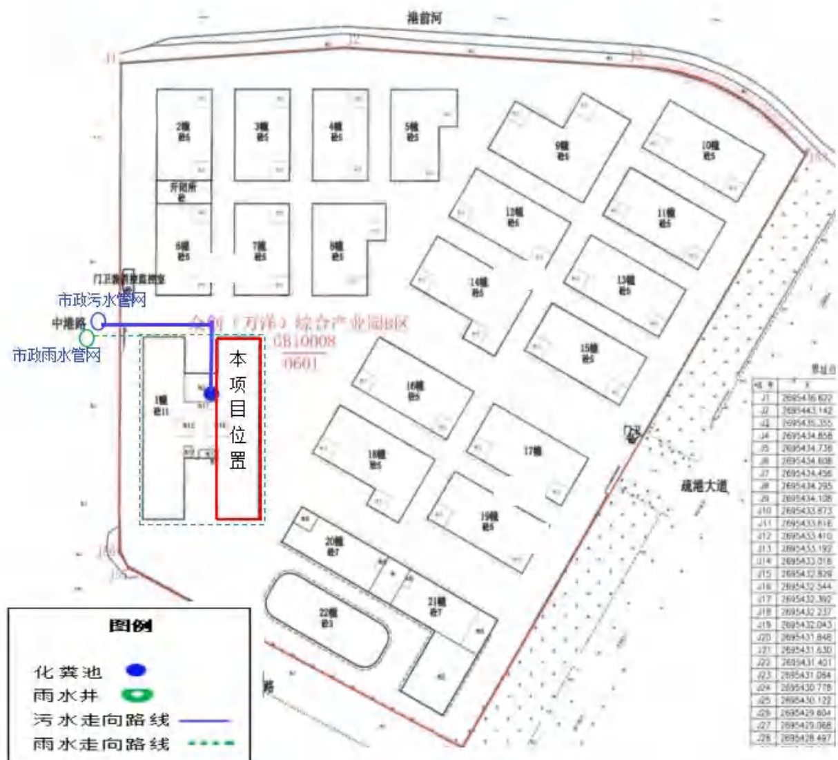
附图 10 项目雨污管线走向示意图
