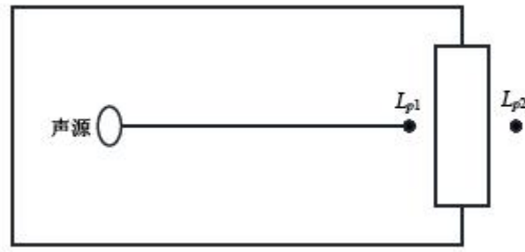
图 5.3-1 室内声源等效为室外声源图例
