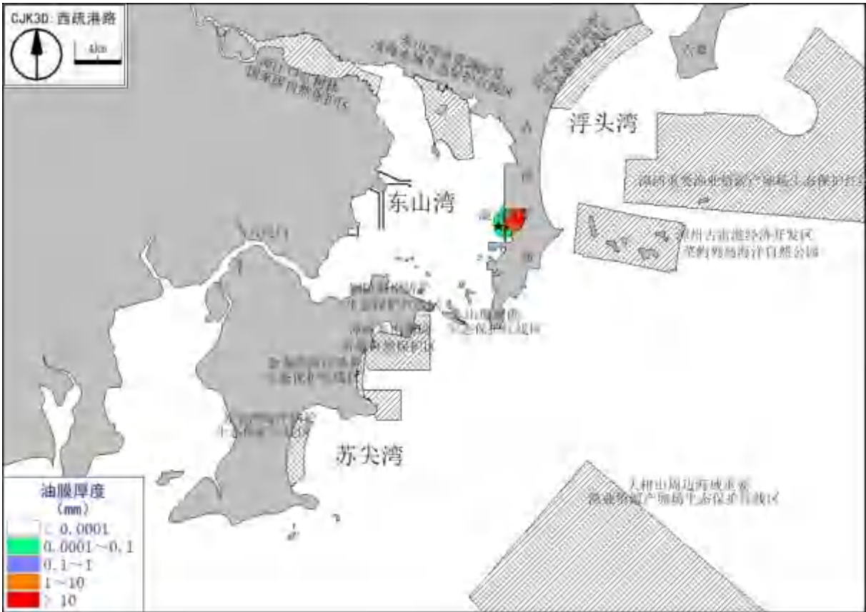
图 5.3-8 夏季主导风向（SW）涨急发生事故 72h 后油污扫海范围
