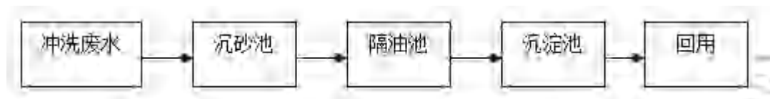
图 6.1-1 生产废水处理措施工艺图
