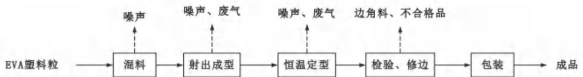
图 2-2 项目拖鞋生产工艺及产污环节图
