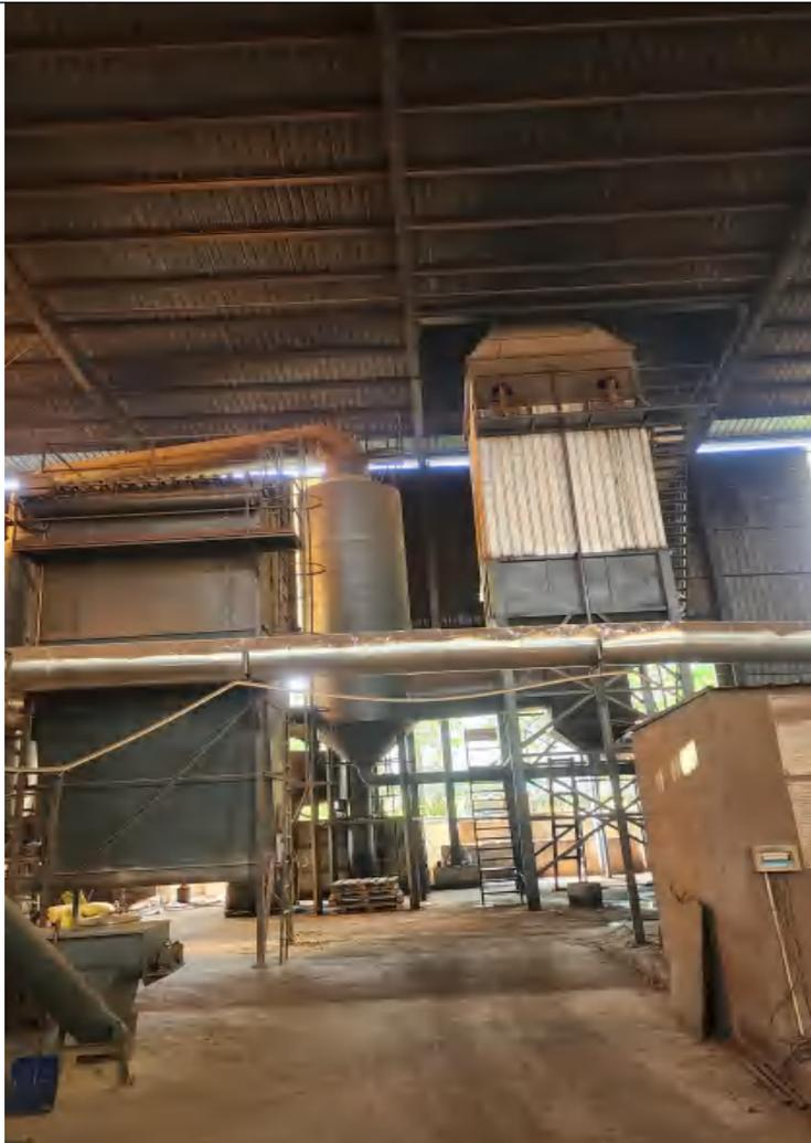
旋风除尘+湿式静电除尘器+25m 高排气筒
