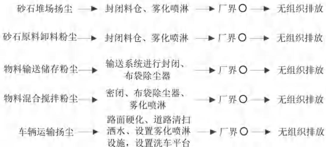
图 3-2 无组织废气处理工艺流程图
