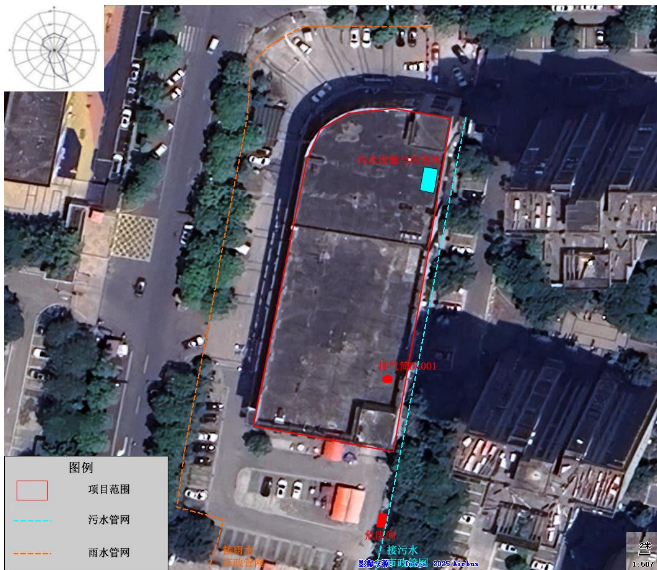
附图 4 厂区总平与雨污管网图
