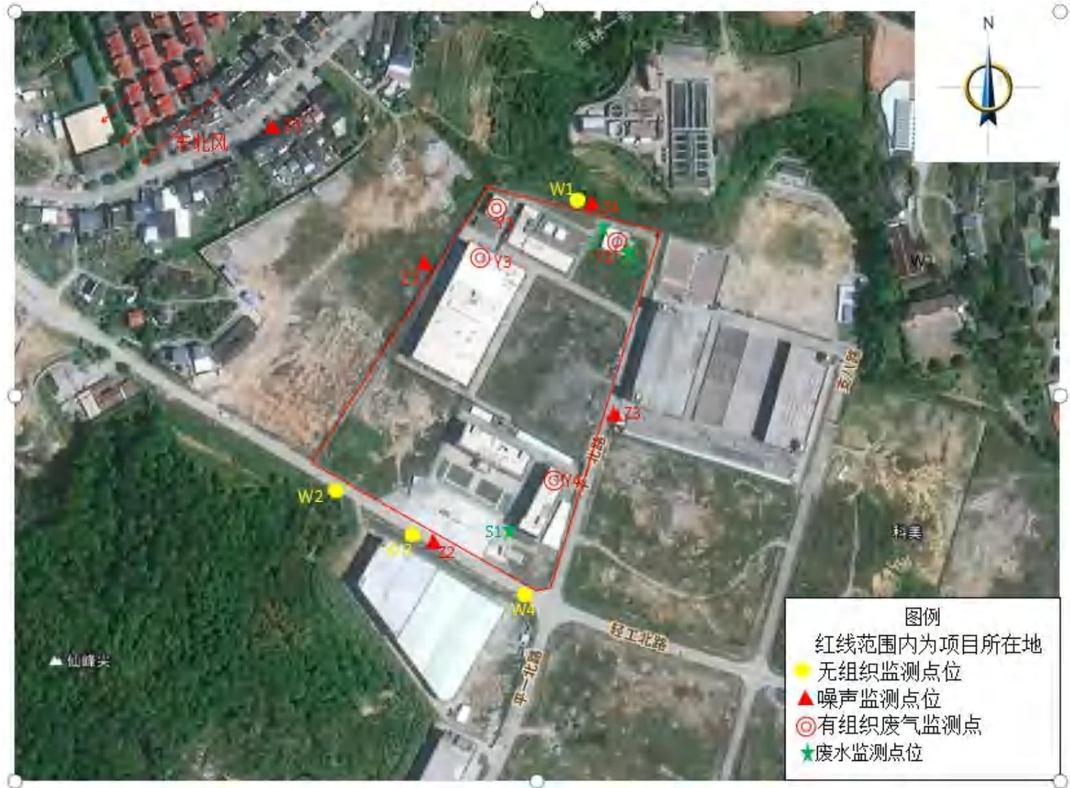
图 7-1 废水、废气、噪声监测点位图
