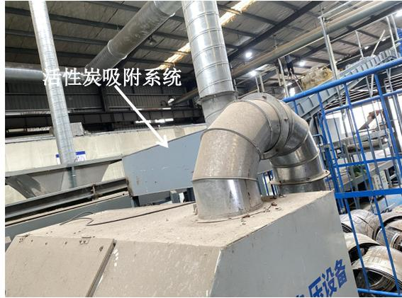
综合拆解线:液晶下负压工位活性炭吸附系统
