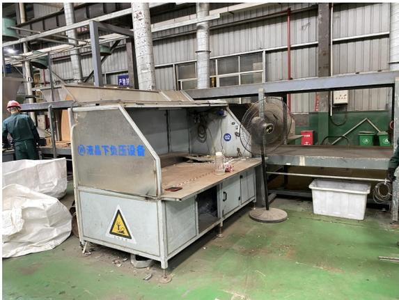
电视电脑拆解线液晶下负压设备
