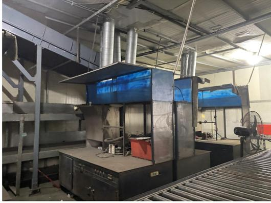
电视电脑拆解线：CRT 分离区集气罩
