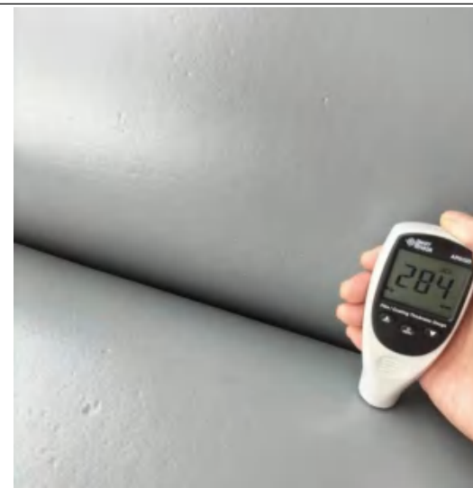
管线漆膜厚度检测
