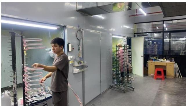
6#、7#水帘喷漆柜废气集气收集
