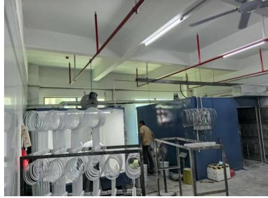
3#烘干废气、1#水帘喷漆柜废气集气收集
