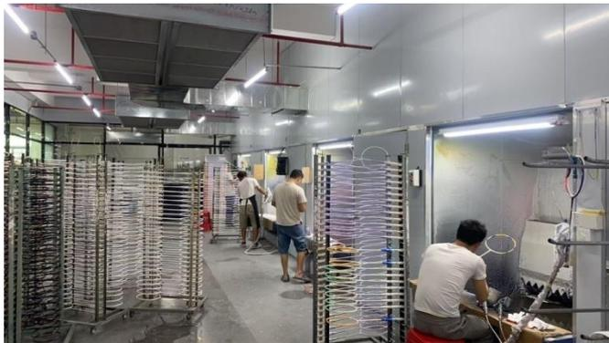
2#-5#水帘喷漆柜废气集气收集
