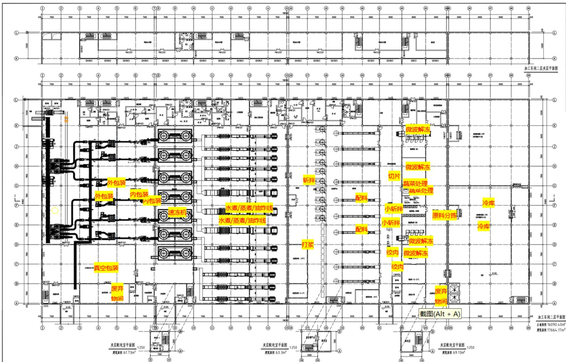
图 2.5 加工车间平面布置图（一层）
