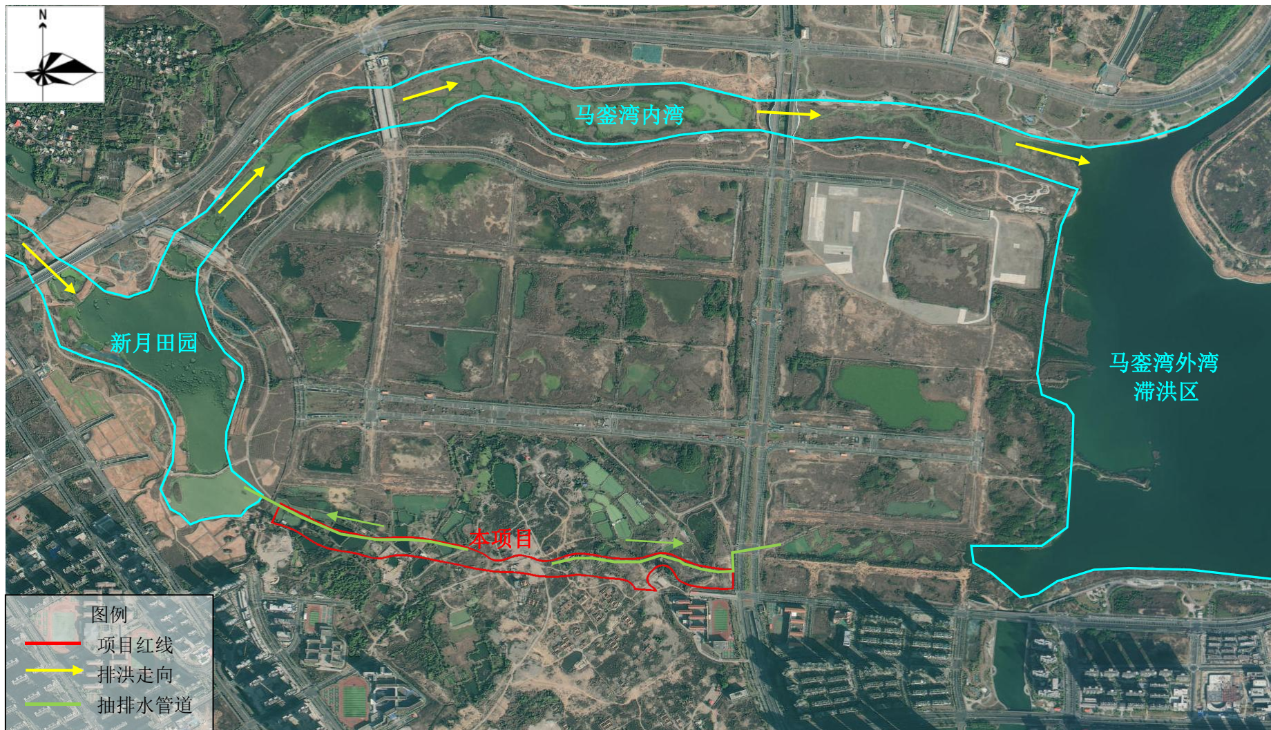
图 4.1-1 本项目施工阶段排洪走向图
