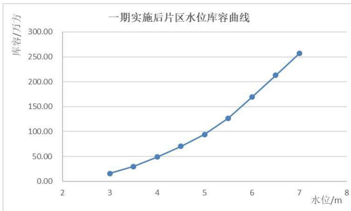
图5.2-1 工程实施完成后西华洋片区水位库容关系曲线
