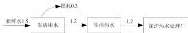
图 3-6 项目水平衡图 (单位: t/d)
