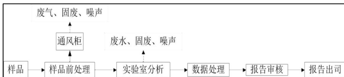
图 2-1 检测实验室工艺流程及产排污环节示意图
