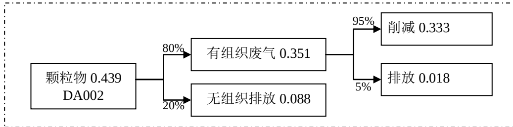
图 4.2-2 抛光粉尘物料平衡图 (单位: t/a)
