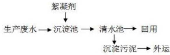
图 4-2 生产废水处理工艺流程图
