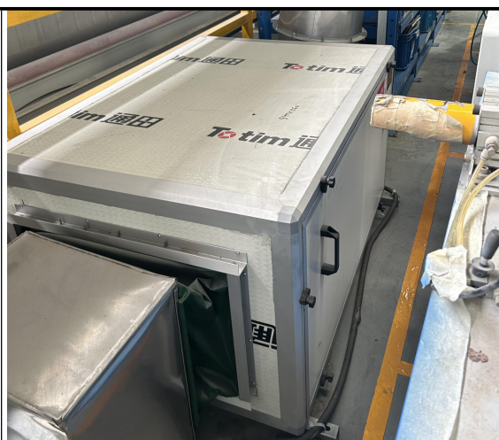
2#厂房 袋式除尘器 TA006 (焊接)
