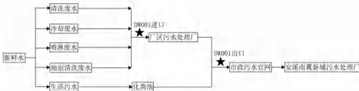
图 3-1 废水监测点位示意图
