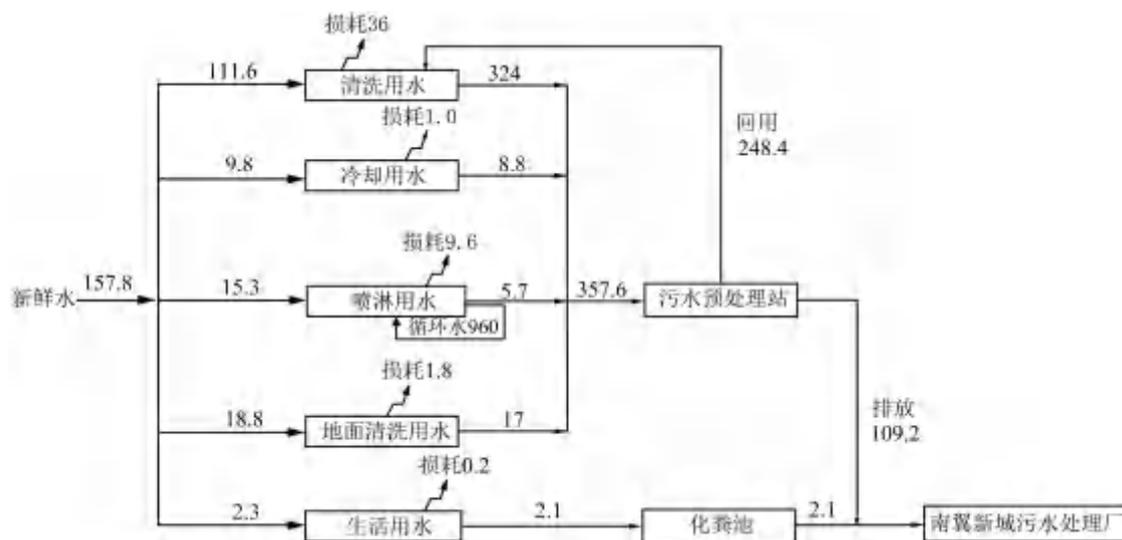
图 2-2 本次验收期间水平衡图 (t/d)
