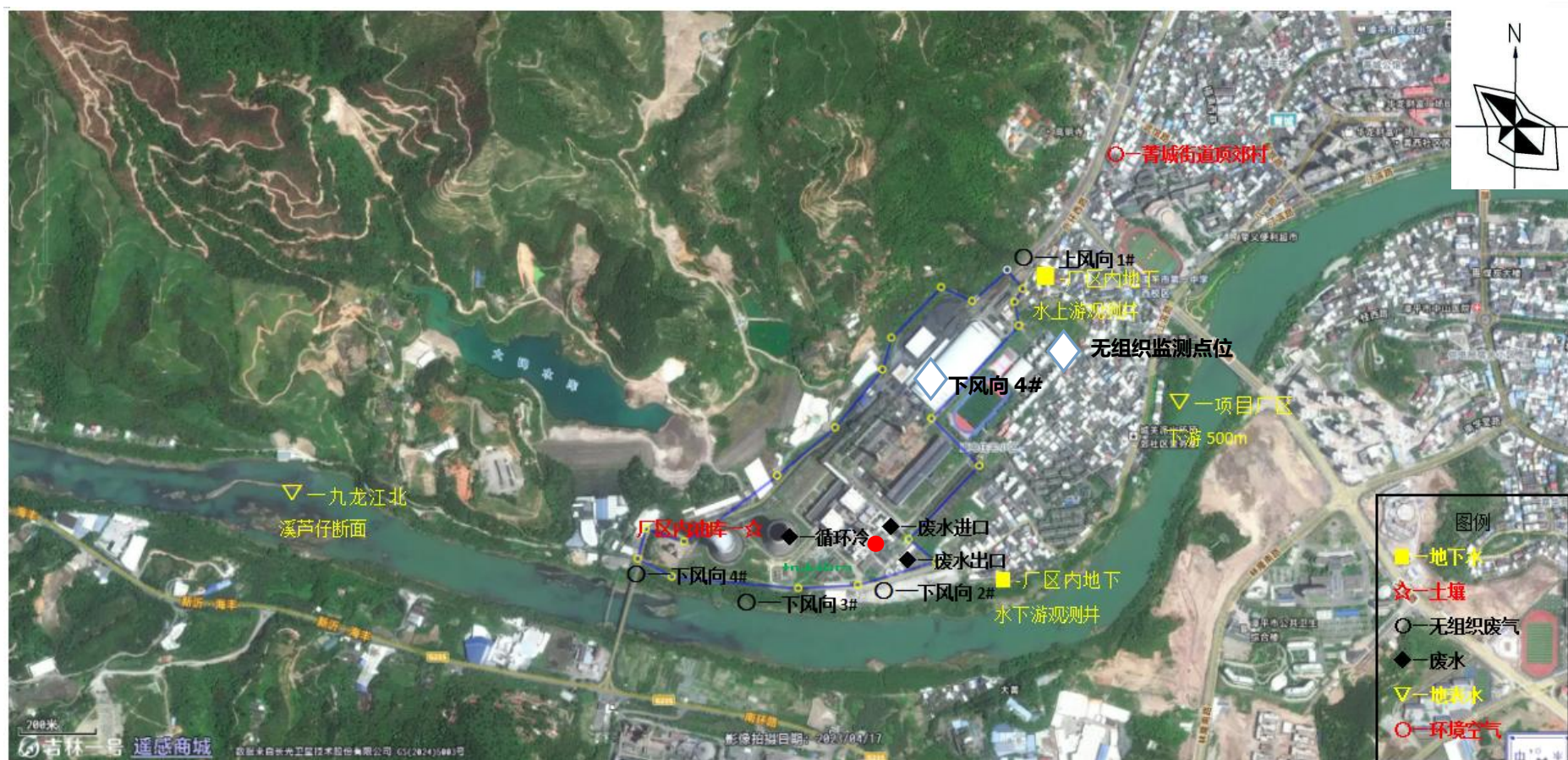
图 33 锅炉废气、厂区无组织废气（非甲烷总烃）、废水处理设施、环境质量监测点位
