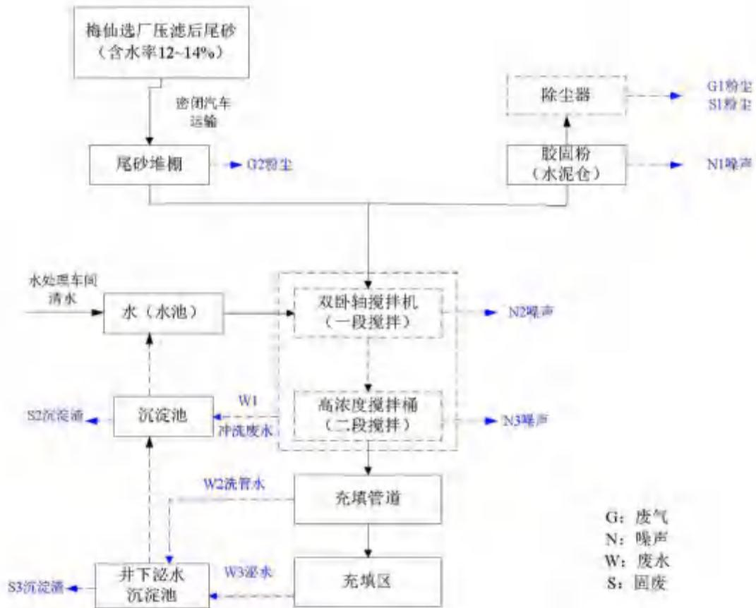
图 3.3-1 尾矿充填工艺流程及产污环节图
