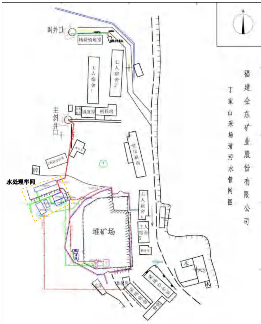
图 3.2-16 采矿区工业场地平面布置图
