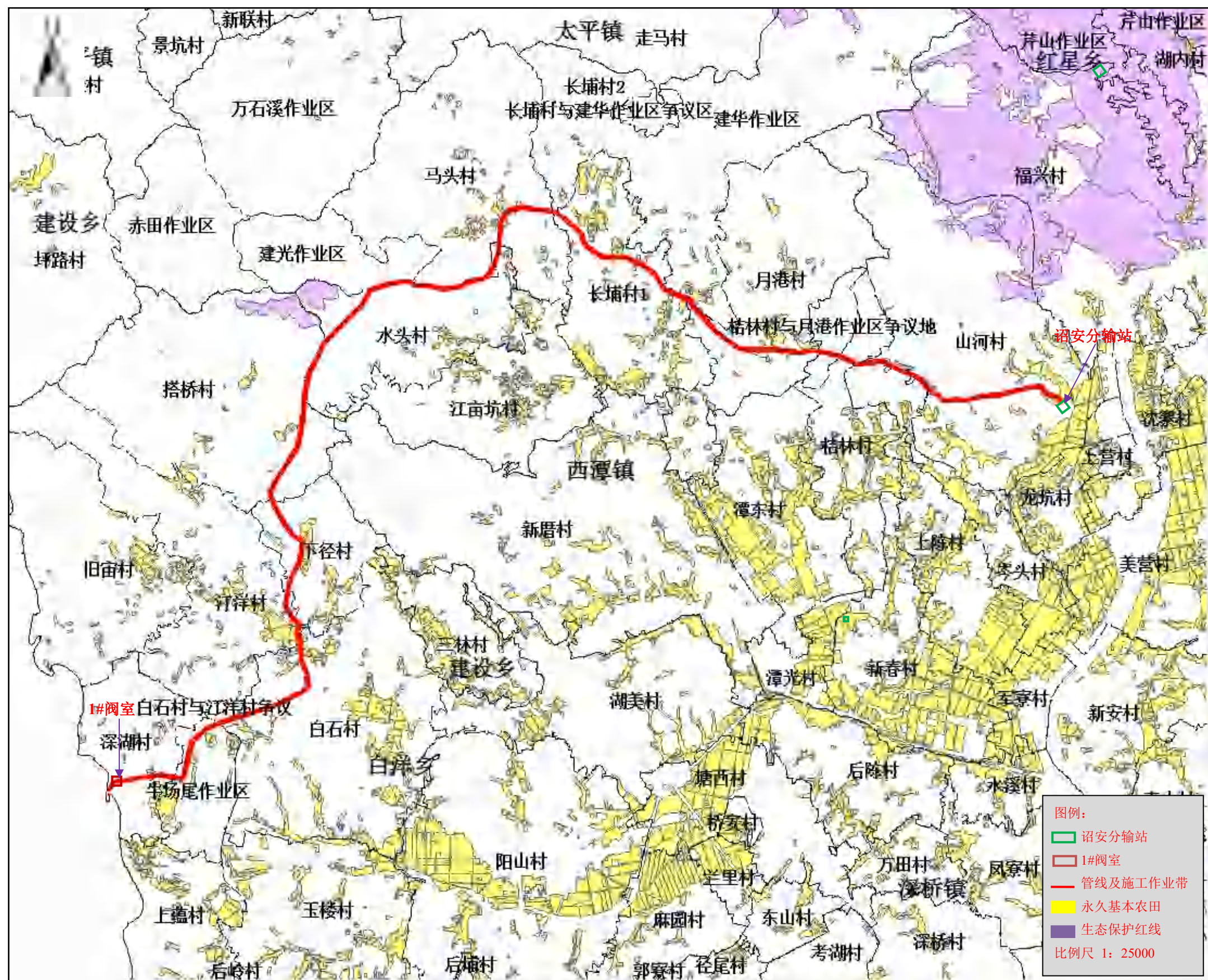
图 2.7-2 管线施工作业带沿线永久基本农田分布情况图
