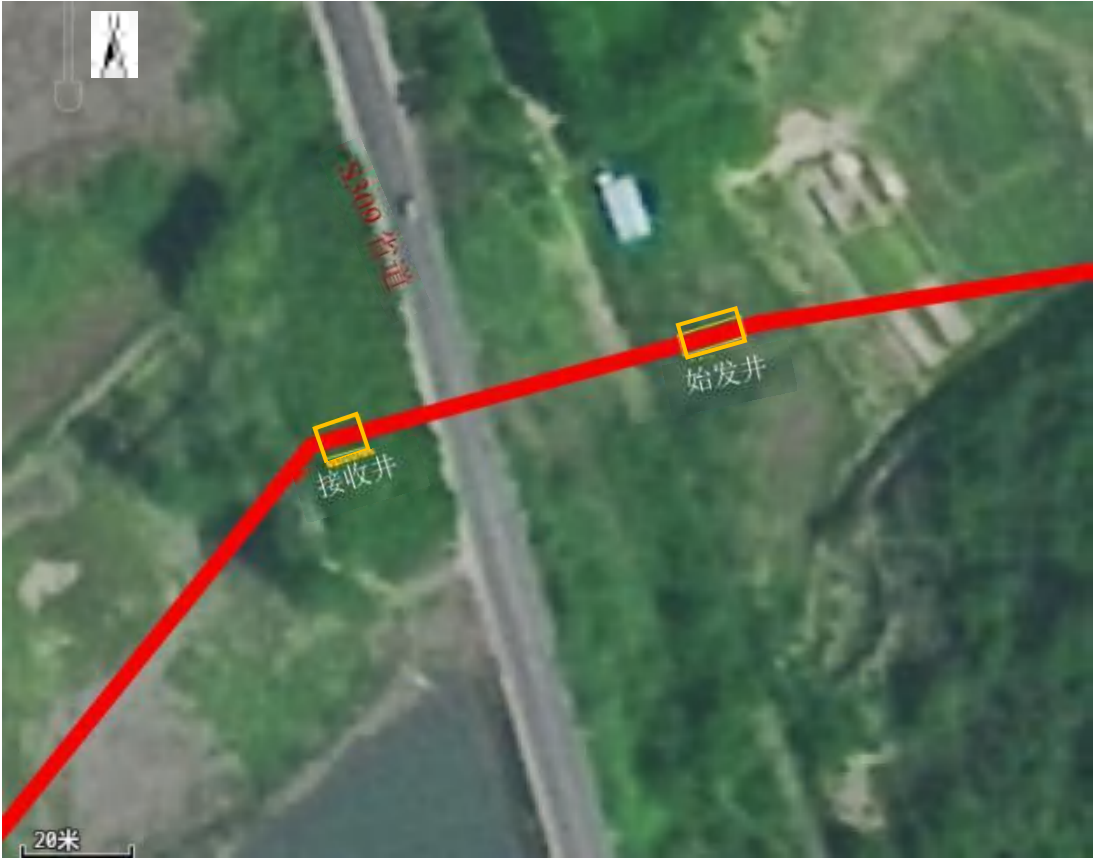
图 3.2-3 顶管穿越 S309 省道示意图
